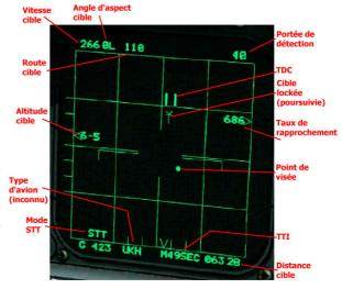
côté droit, avec le chiffre du taux de rapprochement. Les valeurs chiffrées de la distance-cible et de son relèvement sont dans le coin en bas à droite.
