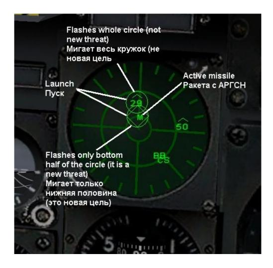
Les positions relatives des symboles de menaces dépendent de la puissance d'Emission du signal. La règle est simple, plus la menace est proche du centre, plus l'Emission est puissante.
